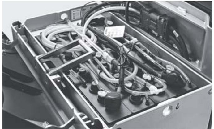
Massima disponibilità grazie alla sostituzione della batteria al piombo-acido laterale di serie per una sostituzione rapida e sicura o alla ricarica intermedia con la batteria agli ioni di litio
